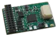
IntelliDrive 2-Decoder mit 21mtc-Schnittstelle, Art.-Nr. 75 335
