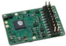
IntelliDrive 2-Decoder mit PluX22-Schnittstelle, Art.-Nr. 74 565
