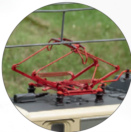
Neu konstruierte Stromabnehmer der Bauart DBS 54 digital heb- und senkbar
