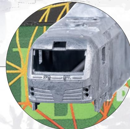
**Lokgehäuse und Träger der Lokomotive aus Zinkdruckguss**
