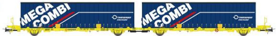
SUTF33317 Doppel Containerwagen Laagrss Transfesa gelb, 2x Container MEGACOMBI Transfesa Ep.VI
