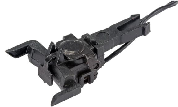
Die von den Lokomotiven der ESU Engineering Edition seit Ende 2021 bekannte, vielfach optimierte elektromagnetische Digitalkupplung ist nun auch separat zur Nachrüstung von Fahrzeugen mit NEM-Schacht verfügbar.
