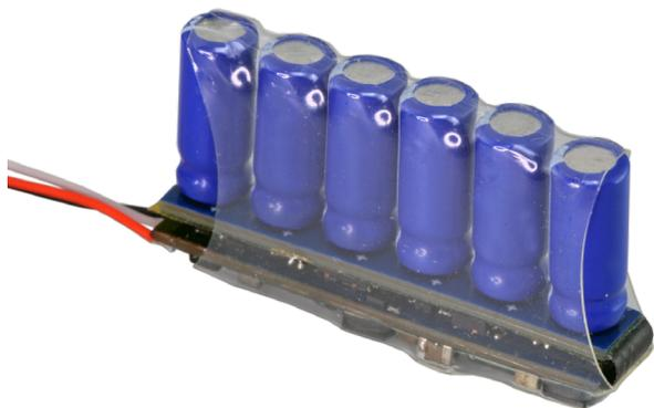
Das ESU PowerPack MiniXS kann an alle ESU-Decoder der fünften Generation (LokSound 5, LokPilot 5, LokPilot 5 Basic) angeschlossen werden und versorgt Ihre Lokomotive beim Überfahren von Dreckstellen und langen Weichenstraßen zuverlässig mit Energie.
