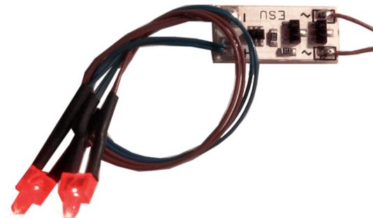
Die kleine, nur 15 mm x 7 mm große Schlußlichtplatine bietet zwei komplett verkabelte, rote LEDs zum Einbau in Ihre Schlußwagen. Sie kommt einbaufertig komplett mit Anschlusslitzen.
