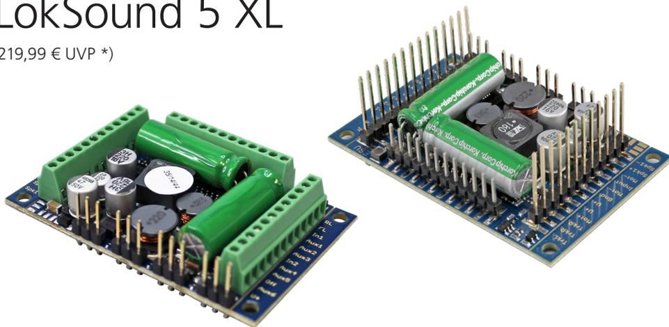
Der LokSound 5 XL Decoder ist ein richtig großer „Brocken“. Das muss er auch sein, denn er ist für den Einsatz in Gartenbahn- oder Spur-1-Loks vorgesehen. Sein integriertes, leistungsmäßig angepasstes PowerPack sorgt für sicheren Betrieb auch auf dreckigen Schienen.
